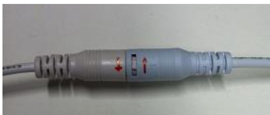
Kuva 5. paneelin ja liitäntälaitteen välillä oleva liitin, jossa nuolet osoittavat liittimien kiertosuunnan lukittaessa liitos.
