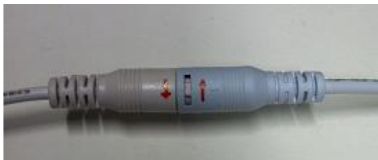
Kuva 5. paneelin ja liitántälaiteen välillä oleva liitin, jossa nuolet osoittavat liittimien kiertosuunnan lukittaessa liitos.
